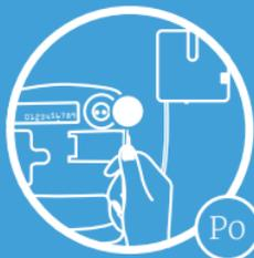
Schließen Sie den Smile P0 an den Zähler an, indem Sie den runden Kopf am Kabel mit dem optischen Port verbinden. Richten Sie den P0-Kopf so aus, dass das Kabel gerade nach unten hängt.
