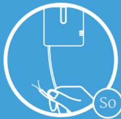
Smile S0 liest den S0-Impulsausgang S0 Klasse A (24 VDC) Ihres S0-Impulszählers aus. Das schwarze Kabel wird vom Installateur mit dem Minuspol (-) und das rote Kabel mit dem Pluspol (+) verbunden.
